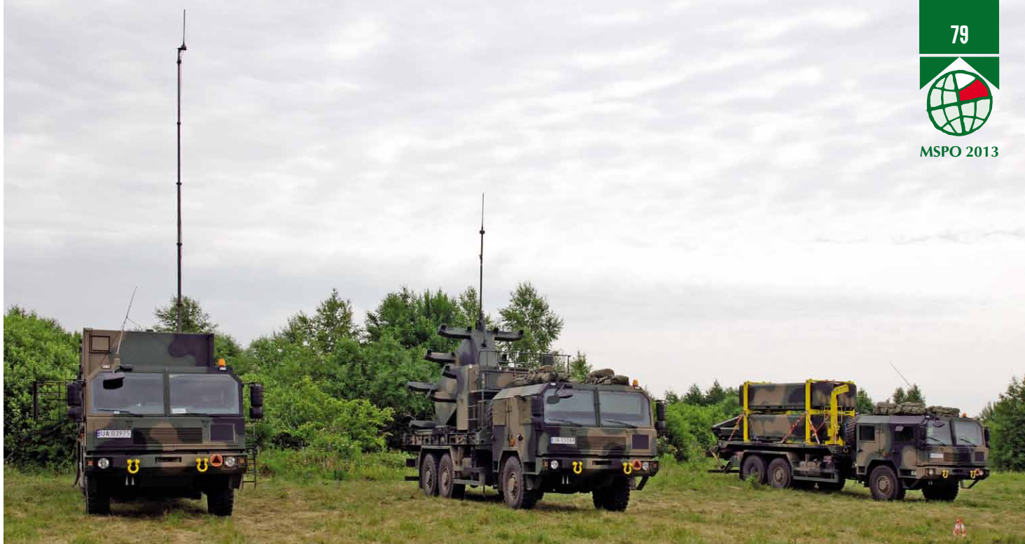
Rdzeń każdej z baterii rakietowych (od lewej): wóz kierowania uzbrojeniem i łączności CCV (Command Control Vehicle), wyrzutnia i wóz transportowo-załadowczy. Dwa pierwsze mają podniesione anteny urządzeń łączności.
