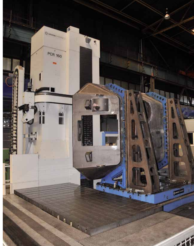
Obróbka wieży armatohaubic Krab na nowej obrabiarce.
