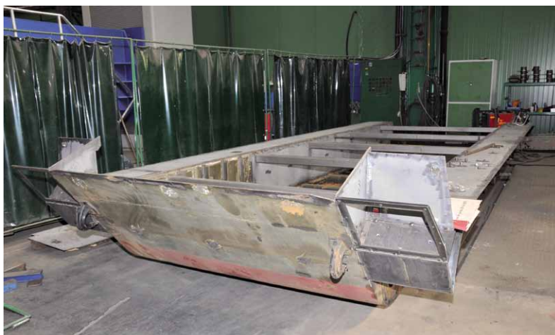
Podwozie haubicy 2S1 służące do zabudowy pod wóz dowódcy. 2S1 howitzer chassis used for the base of Command & Control vehicle.
